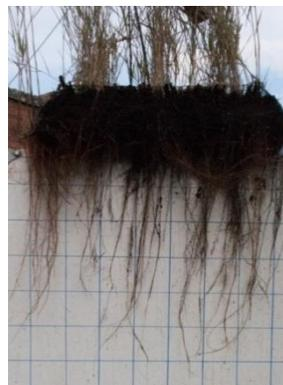
Unterhalb der Inseln schweben die Wurzeln der Pflanzen frei im Wasser und bilden eine hohe Aufwuchsoberfläche für wasserreinigende Mikroorganismen (Günther 2010).
